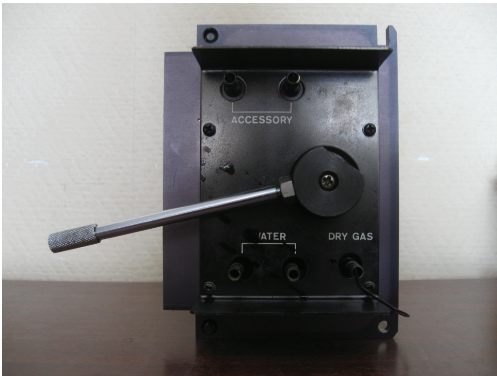
Рисунок 3б. Входные и выходные патрубки подачи газа, воды и пр. с нижней части кюветного отделения.
