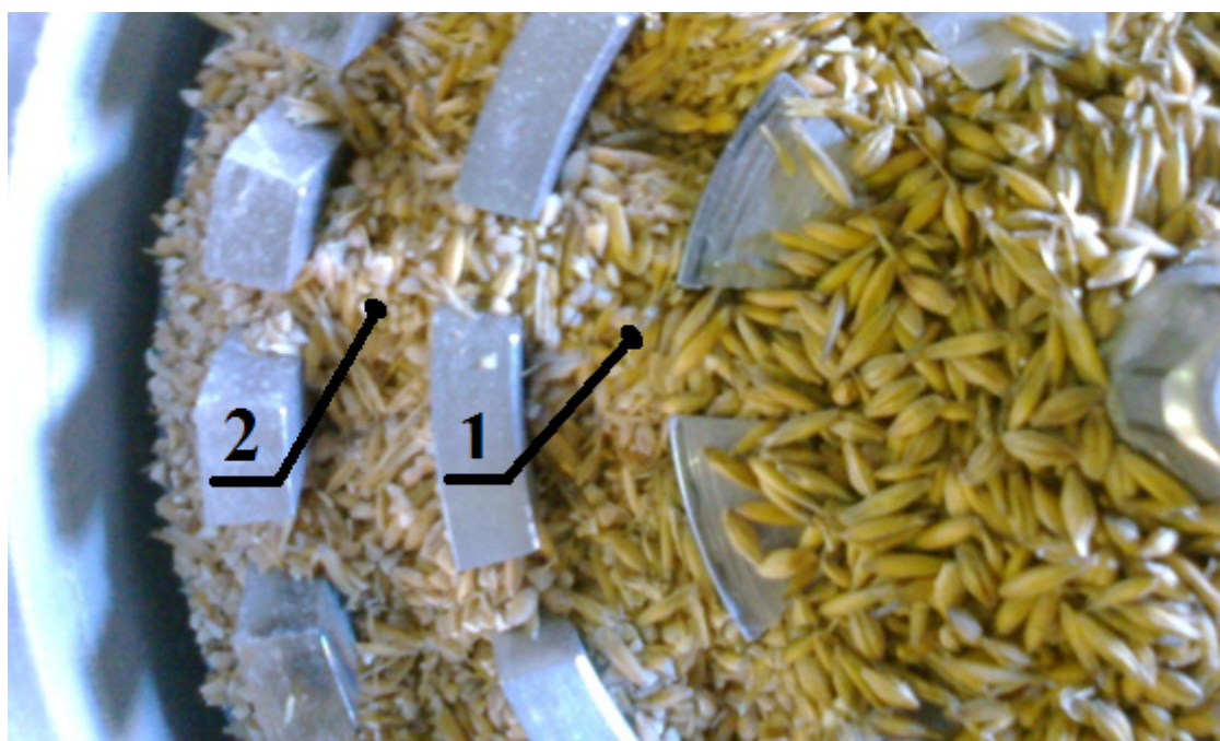
Рисунок 8. Изменение фракционного состава измельчаемого материала по мере его продвижения от центра к периферии измельчителя: 1 – первый кольцевой выступ ротора, 2 – второй кольцевой выступ ротора.
