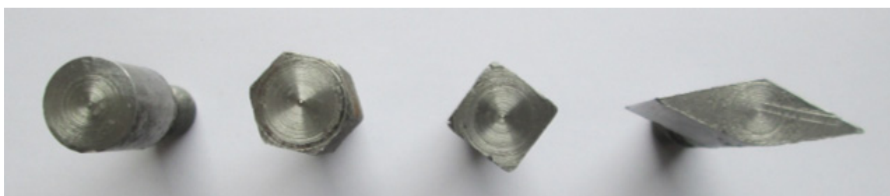
Рисунок 4. Общий вид ножей статора измельчителя фуражного зерна роторно-центробежного типа в боковой проекции: а – круглый; б – шестигранный; в – квадратный; г – ромбовидный.
