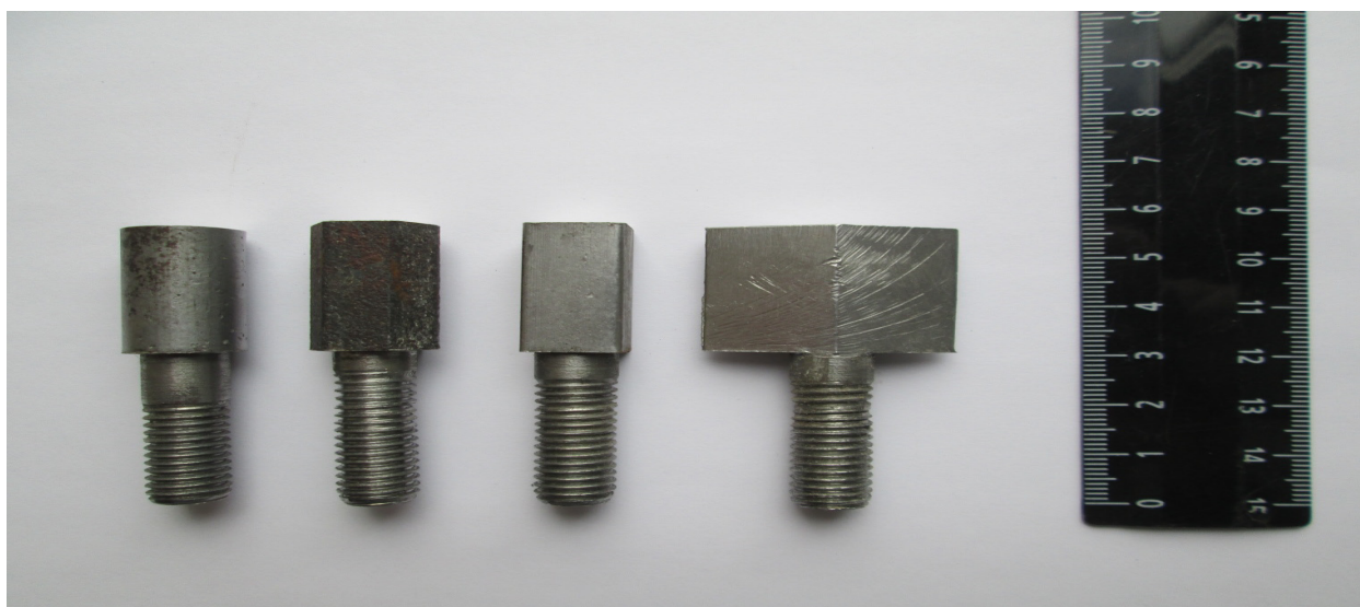
Рисунок 4. Общий вид ножей статора измельчителя фуражного зерна роторно-центробежного типа в боковой проекции: а – круглый; б – шестигранный; в – квадратный; г – ромбовидный.
