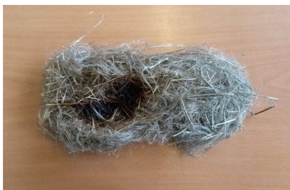
Рисунок 10. Навеска льнотресты с зоной перегрева
