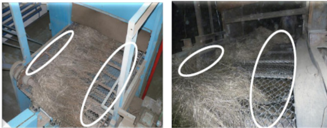
Рисунок 2. Вид слоя льняной тресты на транспортере сушильной машины
