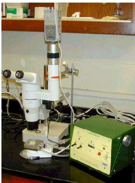
Рисунок 1. Clifton Nanoliter Osmometer под объективом бинокулярного микроскопа (Environmental Institute of Houston)
