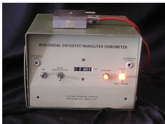
Рисунок 2. Биологический криостат / нанолитровый осмометр. Наверху - охлаждающая камера для микроскопа.
