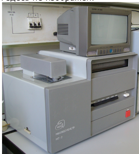
Рисунок 4. Лазерный криоскопический видеомиллиосмометр на базе МТ-2. Конструкция и исполнение автора.
