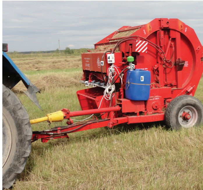
Рисунок 1. Устройство для внесения консервирующих препаратов в растительную массу: 1 – емкость для консерванта; 2 – насос постоянного давления; 3 – счетчик импульсов; 4 – электронный счетчик расхода консерванта; 5 – система трубопроводов; 6 – штанга с форсунками и дублирующим толщиной валка элементом
