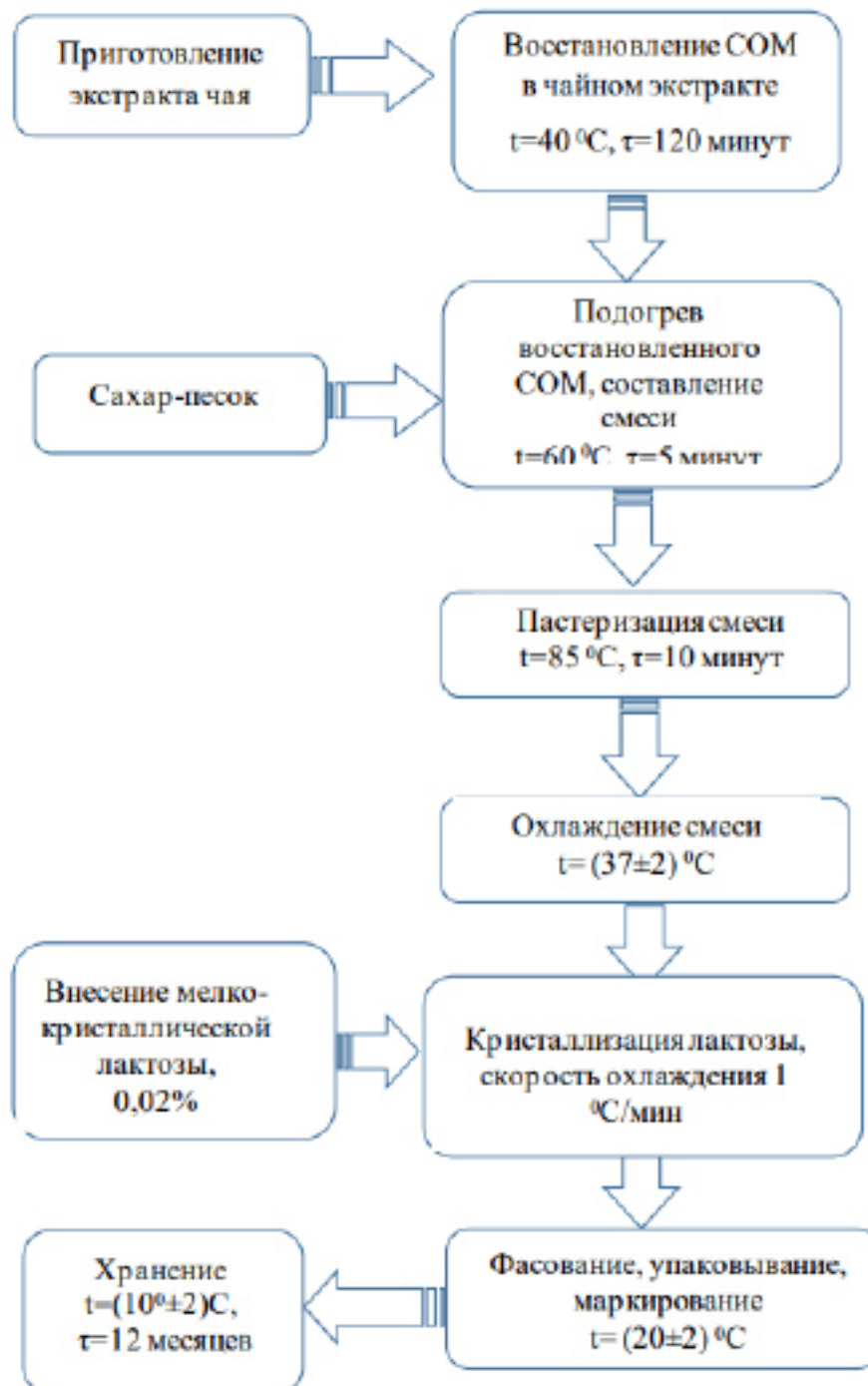
Рис. Технологическая схема производства молока обезжиренного сгущенного с сахаром и экстрактом кипрея узколистного
