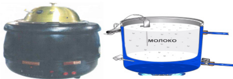
Рисунок 2— Общий вид и принцип работы сыроварни TREMAS-MIX
