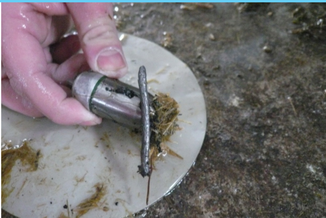
Рисунок 3 – Извлечённое инородное ферромагнитное тело в виде гвоздя
