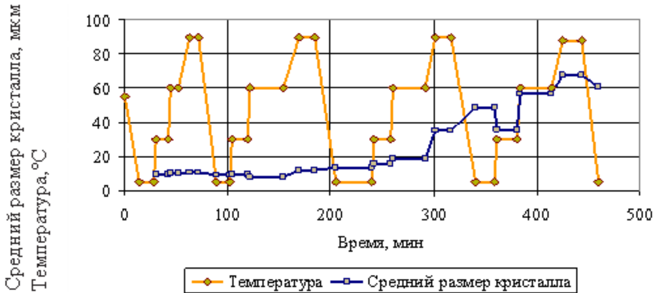
Рисунок 5. Зависимость среднего размера кристаллов образца №1 от времени с учетом изменения температуры.
