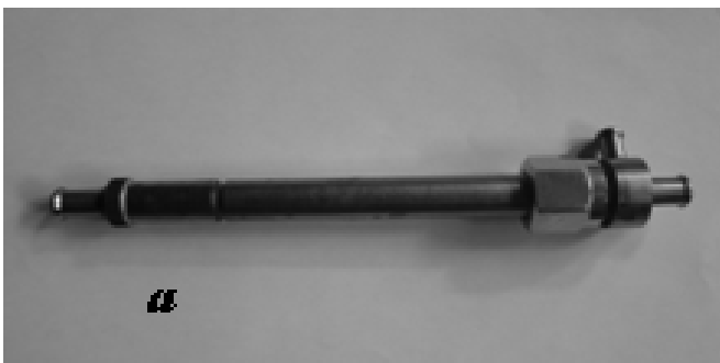
Рисунок 2. Вихревое устройство для получения холодного и горячего воздуха: а – фотография; б – схема: D – диаметр камеры энергетического разделения; Dc – диаметр сопла; Dd – диаметр диафрагмы; L – длина камеры энергетического разделения.
