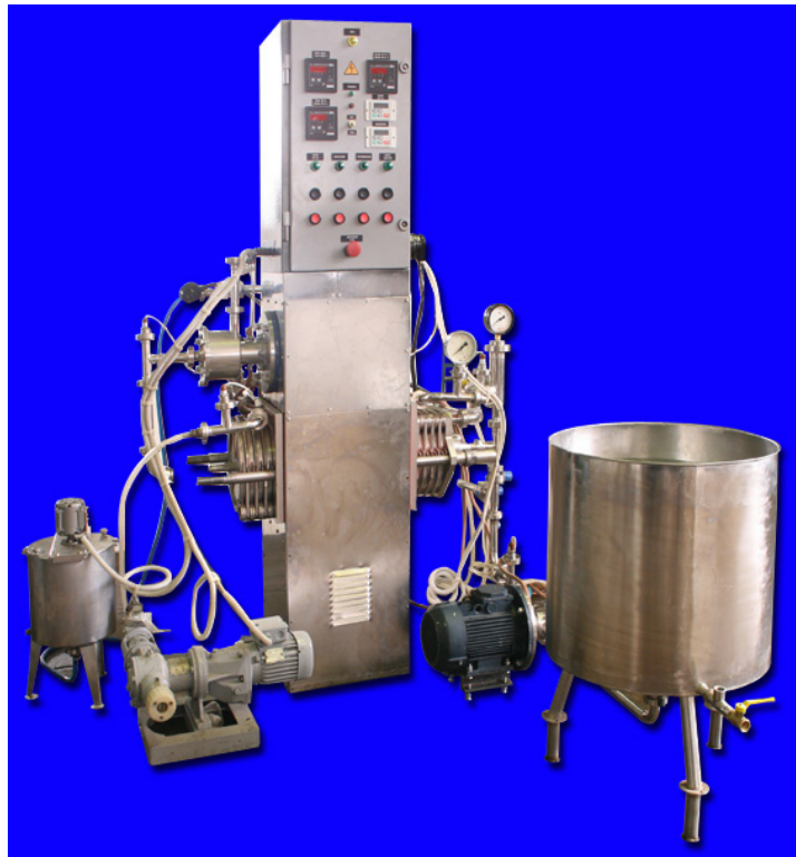
Рисунок 1. Скребокый пластинчатый теплообменный аппарат
