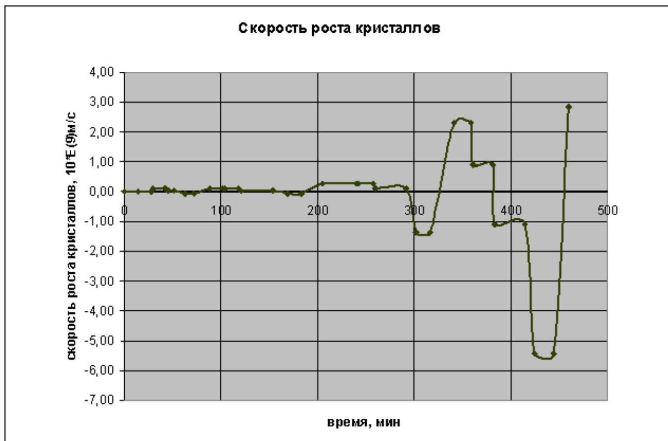
Рисунок 8. Скорость роста кристаллов лактозы при циклических режимах охлаждения и нагревания кристаллизата.
