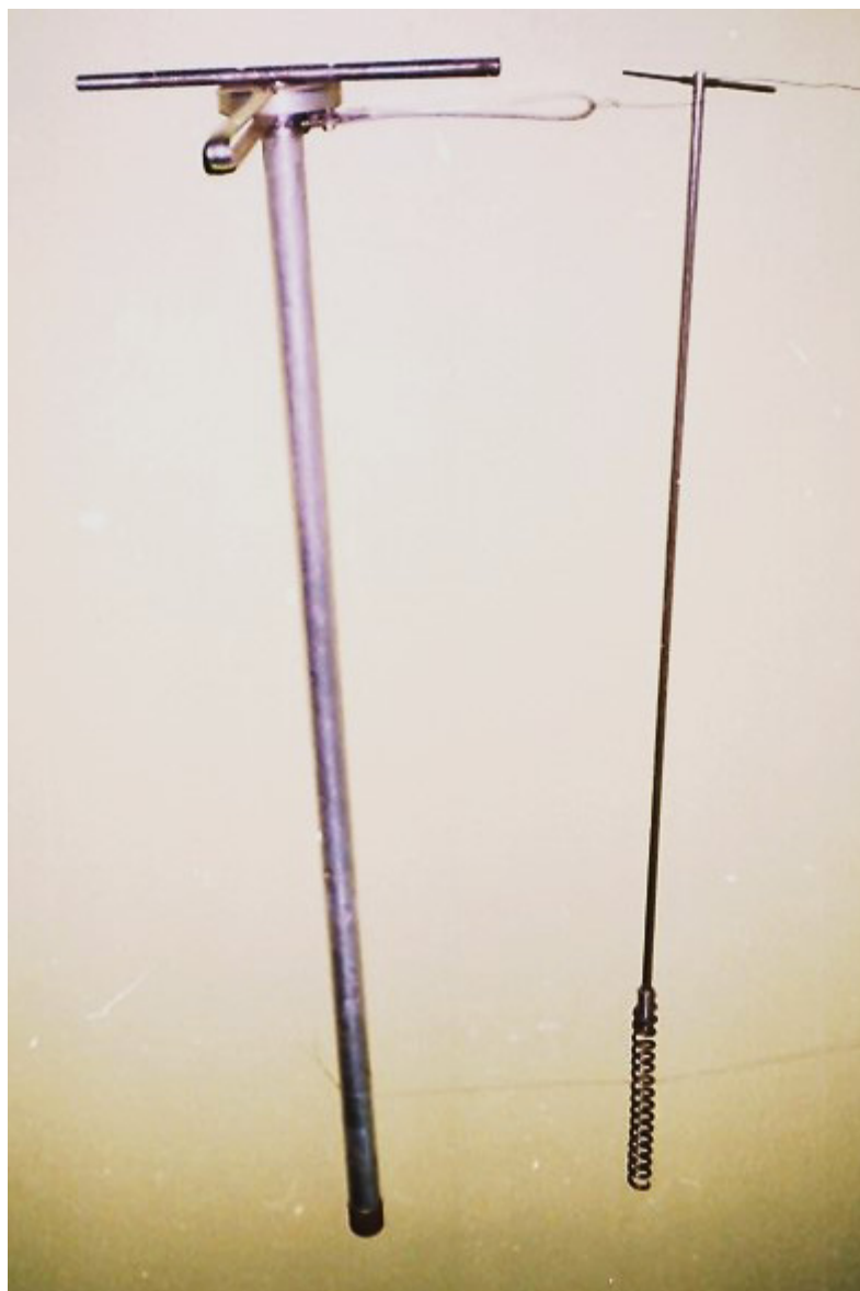
Рисунок 3. Отборник конструкции СЗНИИМЛПХ
