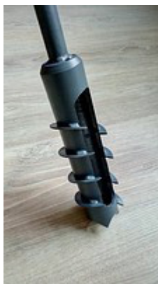
Рисунок 6. Бур (производство Беларусь) (шнек)
