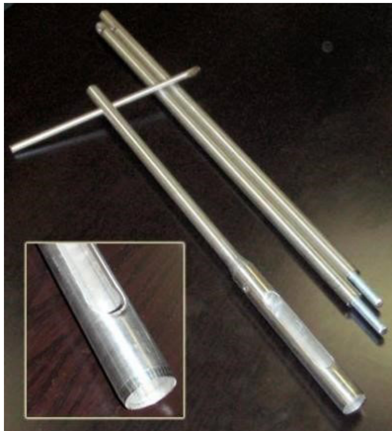
Рисунок 2. Бур-пробоотборник БП-1 для силоса и плющенного зерна конструкции СЗНИИМЭСХ
