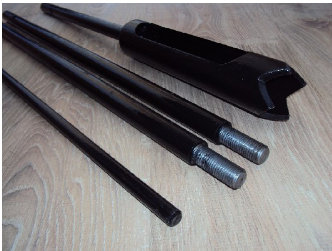
Рисунок 7. Бур (производство Беларусь) (клиновья режущая кромка)
