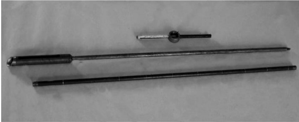
Рисунок 1. Зонд для отбора проб силоса, конструкции ВНИИ кормов им. В.Р. Вильямса
