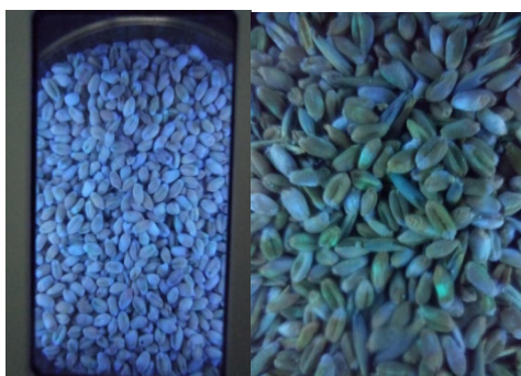
Рис. 2. Люминесцентная диагностика зерна: слева жизнеспособные зерновки, справа – фуражное зерно
