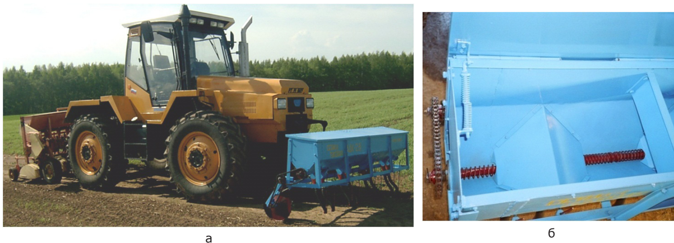
Рисунок 4. Дернинный агрегат АДК-2,8 при агрегатировании с трактором РТМ-160 (а) и высевальные аппараты туковой сеялки (б)
